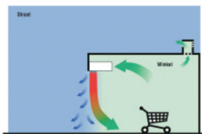
Technologisch principe comfortluchtgordijn
