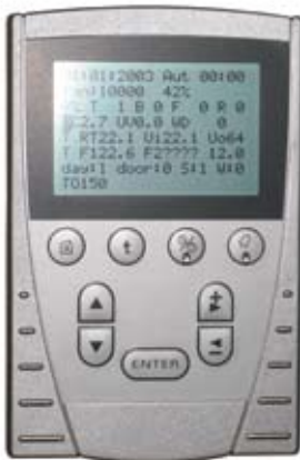
Het plc-regelpaneel is onderdeel van de automatische regeling.
