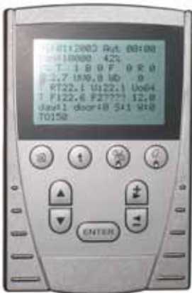
Het plc-regelpaneel is onderdeel van de automatische regeling.
